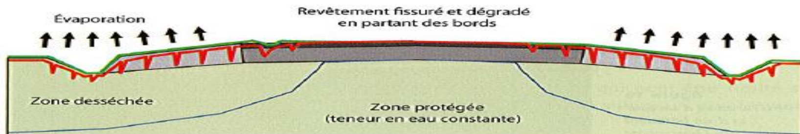
c. Période de pluies : gonflement, disparition des fissures, le sol ramollit, la circulation crée des ornières et des fissures dans la chaussée
