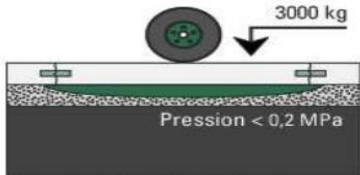
Chaussée (rigide) en béton
