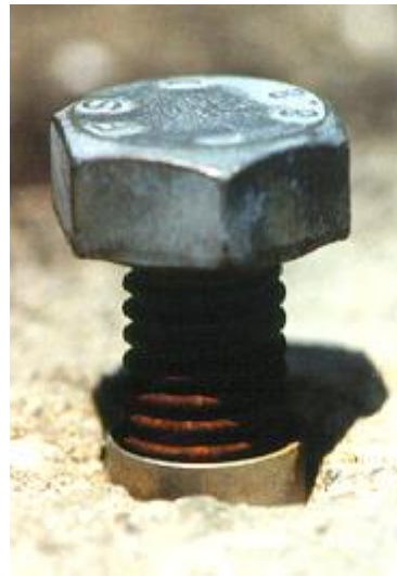
A2 menetes hüvelyben tűzihorganyzott csavar
